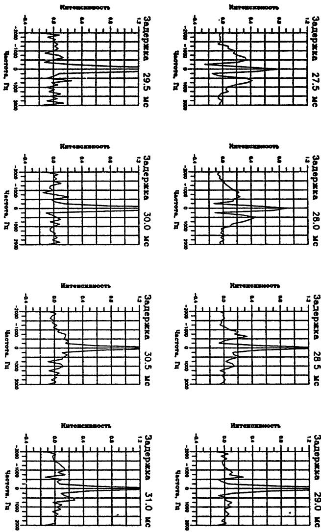
Рисунок 2: Пример спектров сигналов, рассеянных магнитосферой, для различных времен задержки. Каждый спектр усреднен по 85 реализациям. Исключен шумовой уровень, полученный при выключенном передатчике.
