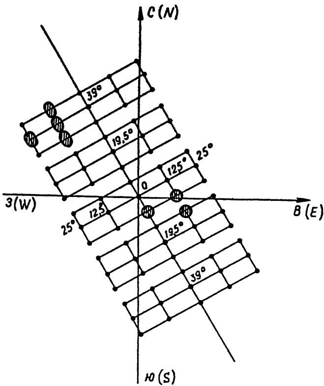
Рисунок 3: Возможные положения луча радара, обеспечиваемые предлагаемыми системами переключения. Переключение внутри каждого прямоугольника обеспечивается электронной системой, в то время как переключение между прямоугольниками — механической.
