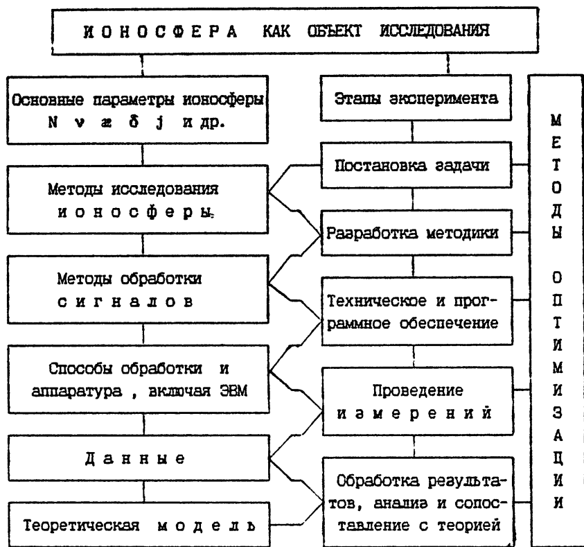
Рис. 2 Структурная схема ионосферного эксперимента
