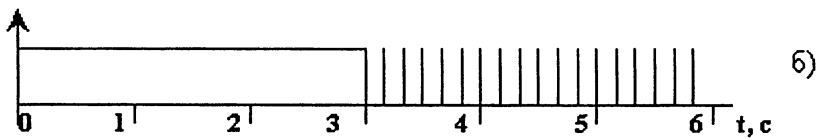
Рис. 1. Схемы: а) создания в ионосфере искусственных периодических неоднородностей ионосферной плазмы, б) режим нагрева и диагностики ИПН.
