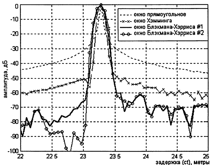
Рис. 5. Амплитуда импульсов во временной области, синтезированных с «закольцованным» СВЧ трактом, при разных весовых окнах в частотной области.
