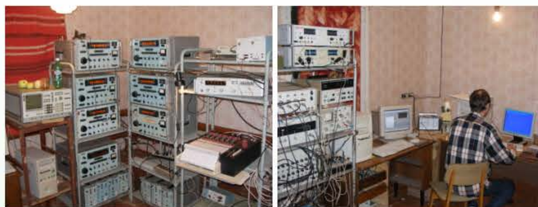
Приемный пункт для регистрации ИРИ на стенде «СУРА». Слева – спектроанализатор HP3585; радиоприемники «Катран» для регистрации динамики сигналов ИРИ на фиксированных частотах. Справа – блок сбора информации с радиоприемников, компьютер с 8-канальным АЦП для регистрации и обработки данных в среде LabView; многофункциональное трехканальное КВ радиоприемное устройство (РПУ) с диапазоном частот 1-30 МГц и динамическим диапазоном 90 дБ, сопряженное с системой цифровой обработки сигнала промежуточной частоты 2500 кГц в полосе до 500 кГц.
