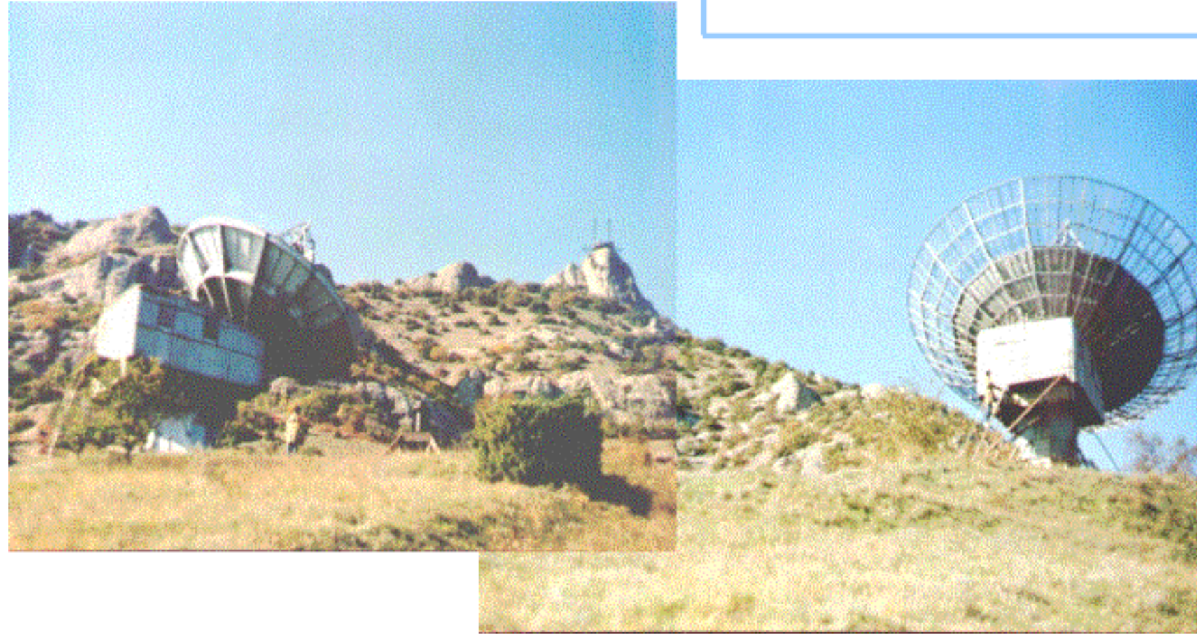
Рис. 1 Радиоастрономическая станция Кара-Даг. Стенд абсолютных измерений. Слева направо: радиотелескоп RT-7; эталон радиоизлучения «искусственная луна»; радиотелескоп RT-12.
