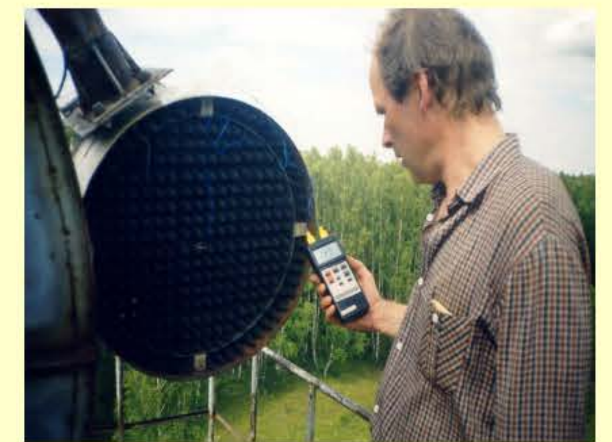
Расположение датчиков электронного термометра для измерения температуры нагреваемого диска
