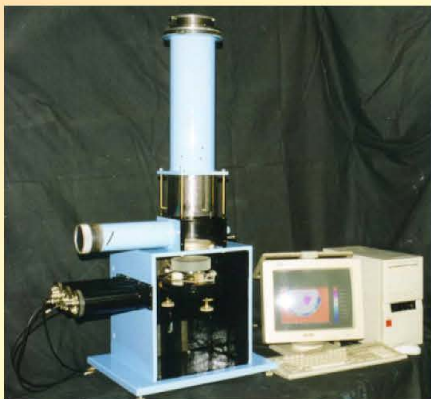
Прецизионный оптический профилометр для 3-х мерного контроля высотных микронеровностей поверхностей плоской формы с размерами до 200 мм в диаметре.
