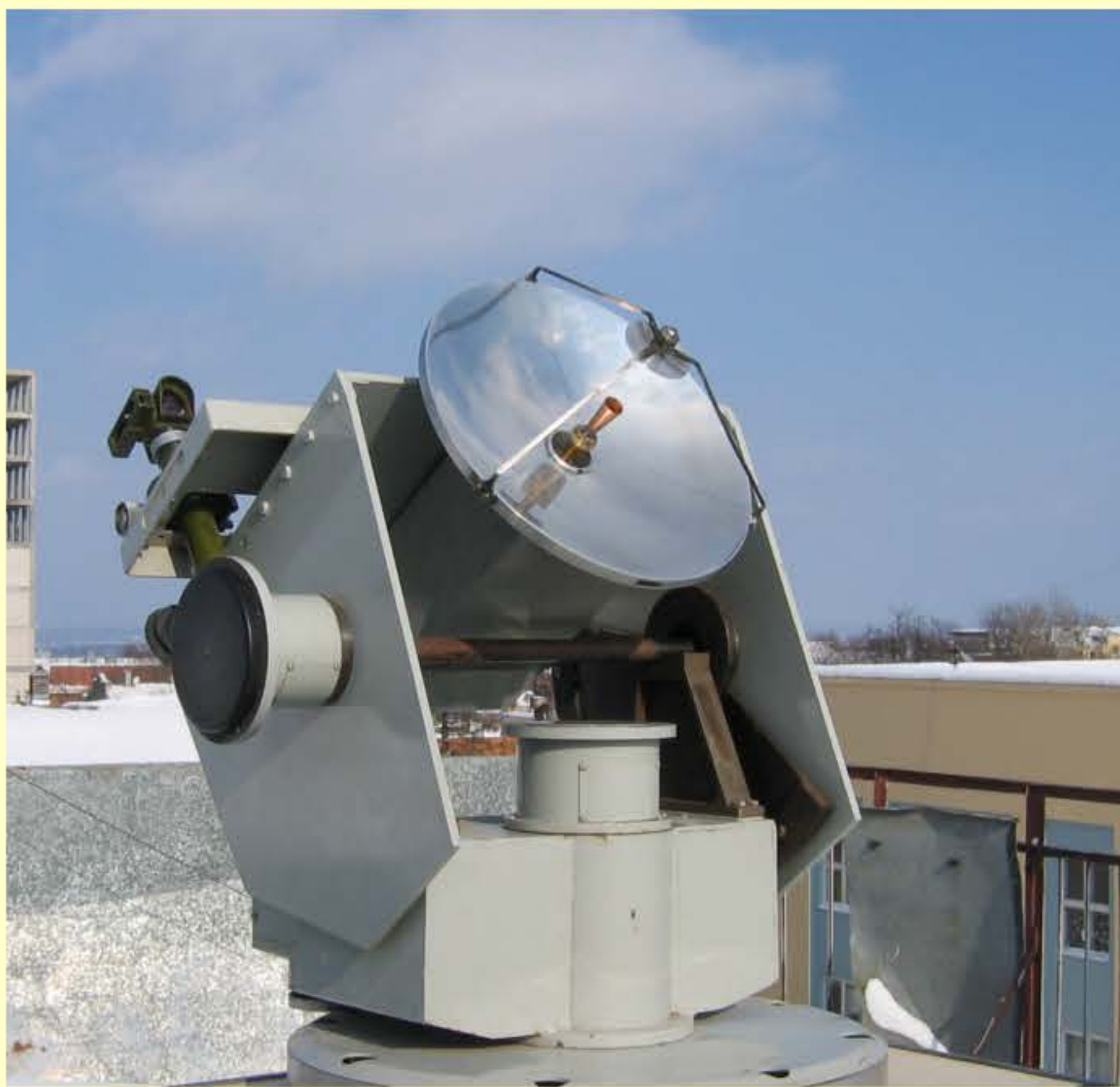
Поляризационный радиометрический приёмник теплового излучения атмосферы на частоте \sim 95 ГГц
