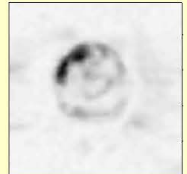
Радиоизображение мины, находящейся на глубине 90мм под поверхностью песка, на которой выдавлен след ладони
