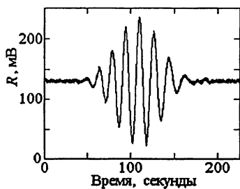
Рис. 1. Сигнал R(t) на выходе интерферометра в сеансе приема сигнала КА на прохождении (26.08.06)
