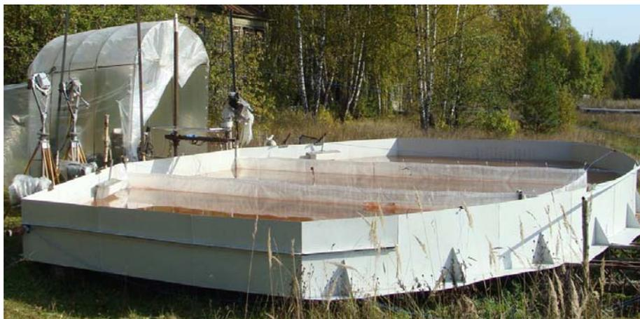
На стенде проведен цикл спектральных измерений излучения поверхности чистой воды и воды с толщиной нефтяной плёнки от 0,2 до 7 мм при трёх типах волнения и высотой волн до 15 см.
