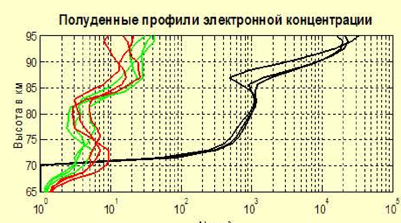
Высотно-временное поведение амплитуды рассеянных сигналов и электронной концентрации 4 апреля 2004 года. Высотные профили электронной концентрации и амплитуды рассеянных сигналов с усреднением на 30 мин.
