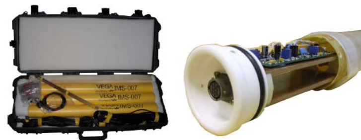
а) Внешний вид комплекта датчиков IMS-007. б) Предварительный усилитель. Таблица 2
