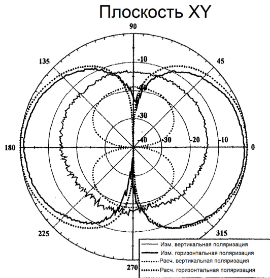
Рисунок 4.6 – Диаграммы направленности (ДН), экспериментальные (сплошная линия) и рассчитанные (пунктирная линия) для квадратной рамочной антенны, ортогональные поляризации
